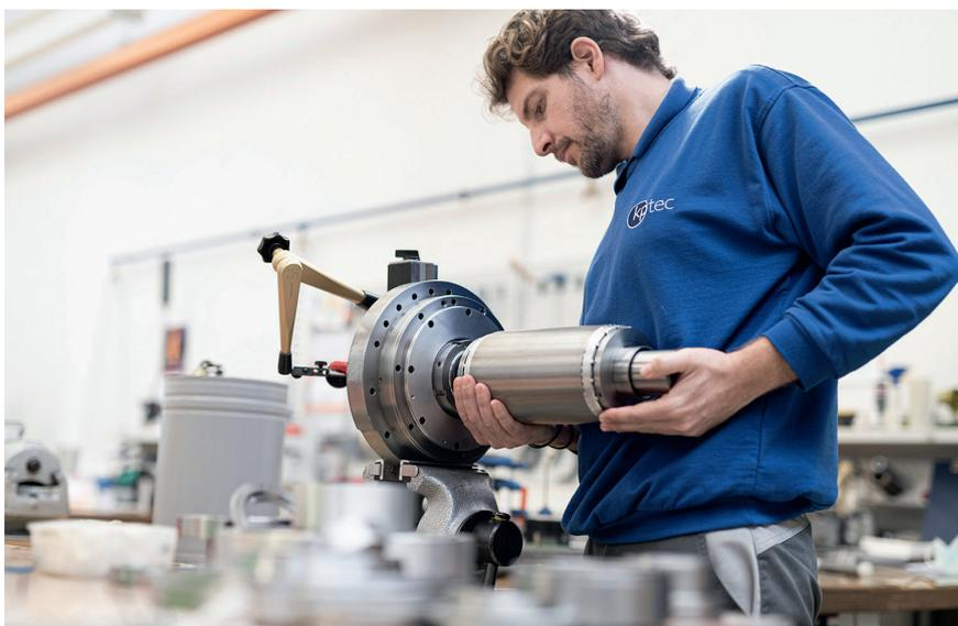
1 Kptec repariert, überholt und prüft Bearbeitungsspindeln von Werkzeugmaschinen
