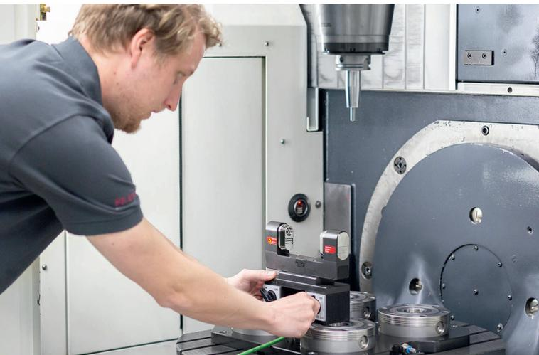
3 Teil des Systems ist das aus den Bearbeitungszentren bekannte Lasermesssystem LC50-Digilog. Es wird einfach mittels Magnethalter auf dem Bearbeitungstisch der Werkzeugmaschine befestigt
