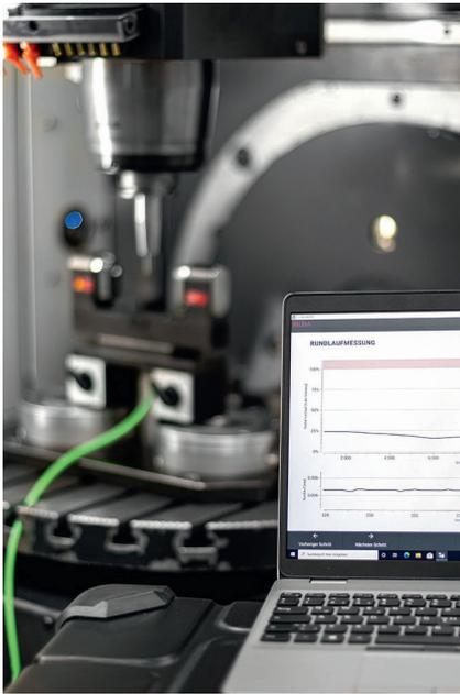
2 Kptec nutzt zur mobilen Spindelüberwachung 'Portable SpindleControl' (PSC), ein hochpräzises, tragbares System zur flexiblen Prüfung und Überwachung von Motorspindeln in Werkzeugmaschinen
